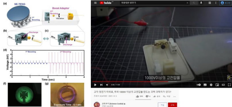
[a] 출력 부스트 어댑터의 개략도. b,c) 마찰전기 출력 증폭 메커니즘. d) 마찰전기 출력 전압(5000V) f) 크록스 튜브 및 g) 플라스마 구동 사진 [ 관련 기술 과학 유튜브 홍보 (조회수 2만회 이상) ]
